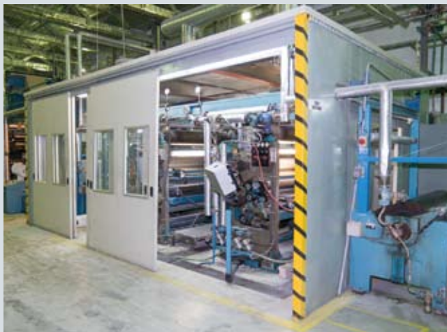
На фото слева агрегат для изготовления микрогофрокартона с одновременной приклейкой запечатанного верхнего лайнера, справа — вырубной пресс для гофрокартона
