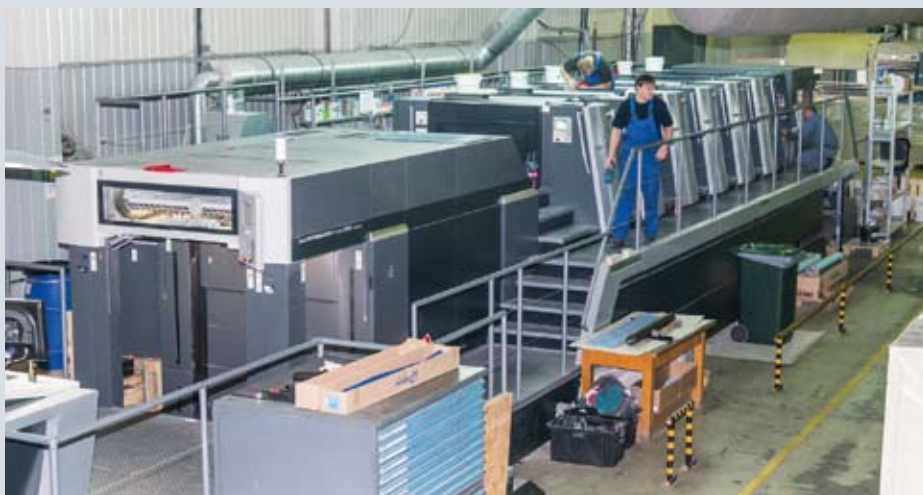
В цехе офсетной печати типографии работают многокрасочные печатные машины только немецкого производства. На фото — новейшая печатная машина Heidelberg Speedmaster XL 106 с самым современным оснащением
