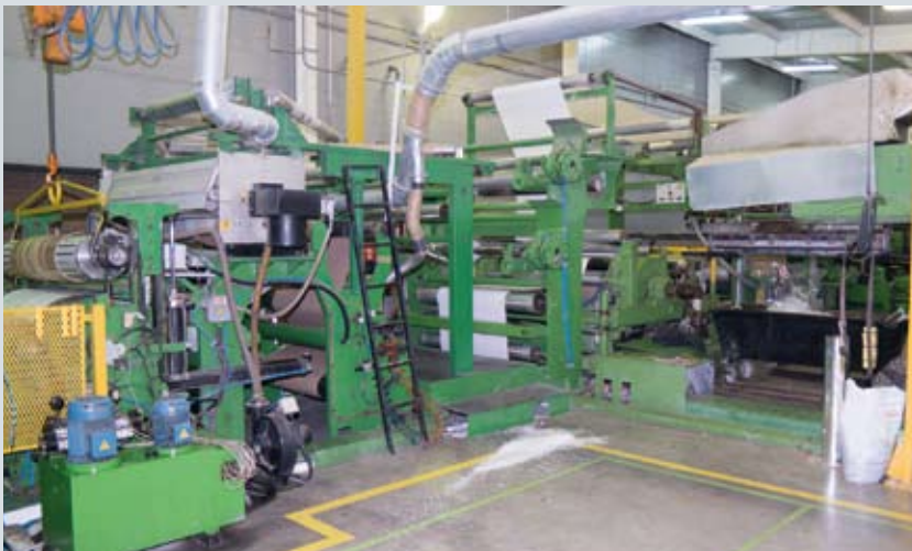
Промышленный ламинатор, совмещенный с мощным щелевым экструдером. Эта комбинация позволяет производить картон с барьерным слоем внутри картонных или бумажных слоев
