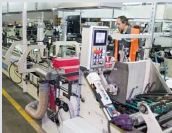
На этой фальцесклеивающей машине установлена автоматическая система сквозного оптического контроля заготовок и отбраковки дефектных изделий
