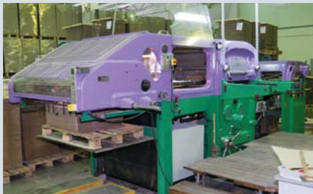
На фото слева агрегат для изготовления микрогофрокартона с одновременной приклейкой запечатанного верхнего лайнера, справа — вырубной пресс для гофрокартона
