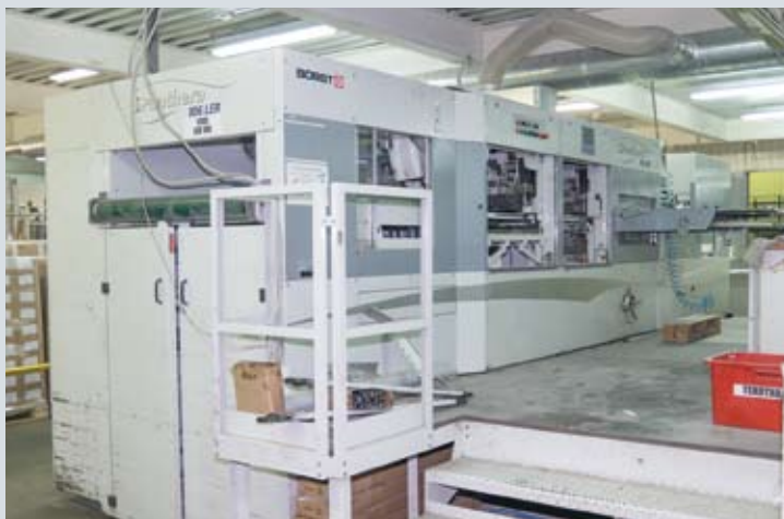
На этой фальцесклеивающей машине установлена автоматическая система сквозного оптического контроля заготовок и отбраковки дефектных изделий
